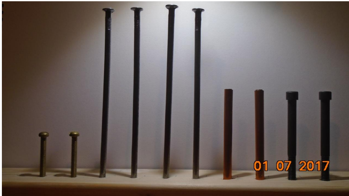
Εικόνα 5) Το δείγμα της έρευνας πριν τοποθετηθεί σε εξωτερικό χώρο για να οξειδωθεί
