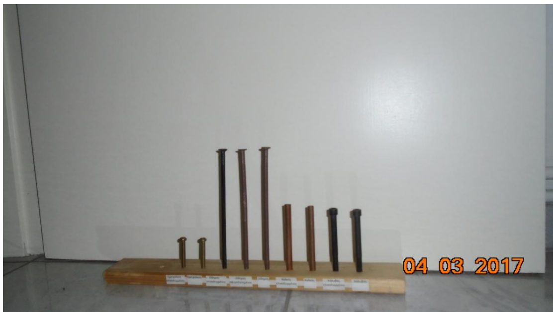
Εικόνα 5) Το δείγμα της έρευνας πριν τοποθετηθεί σε εξωτερικό χώρο για να οξειδωθεί
